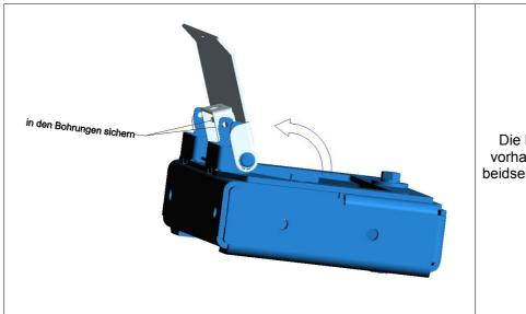
Die Druckplatte in den vorhandenen Bohrungen beidseitig gegen zuklappen sichern.
